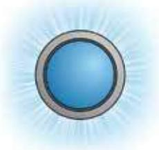
Температура силиконового вала снижается до 150°C (заводская настройка). Режим ожидания может быть прекращен нажатием на голубую лампочку ожидания (1.21), в таком случае температура снова поднимется до заданной температуры горячего тиснения и мерцание лампочки прекращается. Заводская настройка режима ожидания (2 мин, 150°C) может быть изменена по желанию покупателя.
